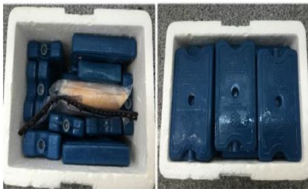
Figura 3 - Sugestão de acondicionamento de amostras refrigeradas e congeladas. Deve-se garantir que não haja contato direto com a amostra.
